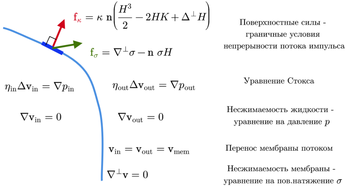
Рис. 1: Схематическая запись уравнений, определяющих динамику мембраны.
